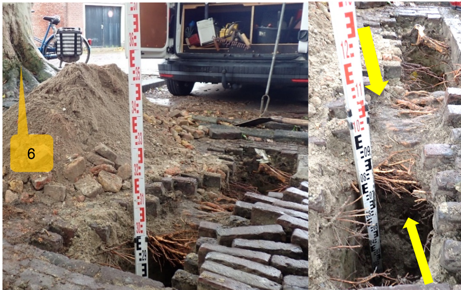
Foto 5: Links: profielsleuf 2 (P2) met grondboring bij boomnummer 6, 1,8 m uit de stamvoet ter noordwestzijde. Rechts: detailfoto P2, de gele pijlen geven een deel van de wortelmat aan en de gestelwortel met Ø 145 mm.
