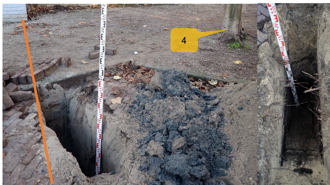
Foto 4: Links: profielsleuf 1, 3,2 m uit stamvoet aan de oostzijde, bij boomnummer 4. De oranje lijn geeft de nieuwe gevellijn aan. Rechts: detailfoto profielsleuf 1.
