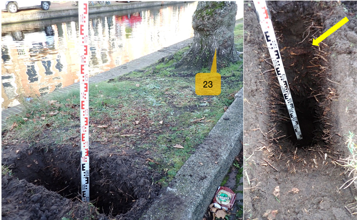
Foto 11: Links: profielsleuf 6 (P6) bij boomnummer 23, 2,9 meter uit de stamvoet. Rechts detailfoto van P6, de gele pijl duidt de wortel met \varnothing 60 mm aan.
