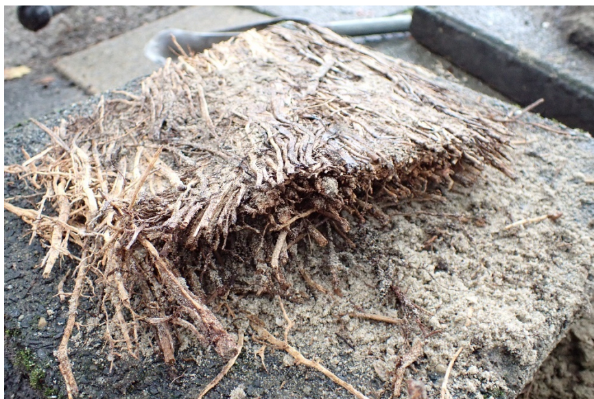
Foto 9: aangetroffen wortelmat bestaande uit fijne beworteling Ø 1-20 mm in P4.
